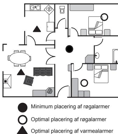
I 2 eller flere plans beboelse bør der som minimum placeres en røgalarm på hver etage i trappeopgangen. For optimal sikkerhed placeres røgalarmer i alle rum med undtagelse af køkken, badeværelse og garage, da mados, damp og udstødning kan udløse røgalarmen. Istedet anbefales det at placere en varmealarm i køkkenet max 5,3 meter fra varmekilde. Se fig. 2
